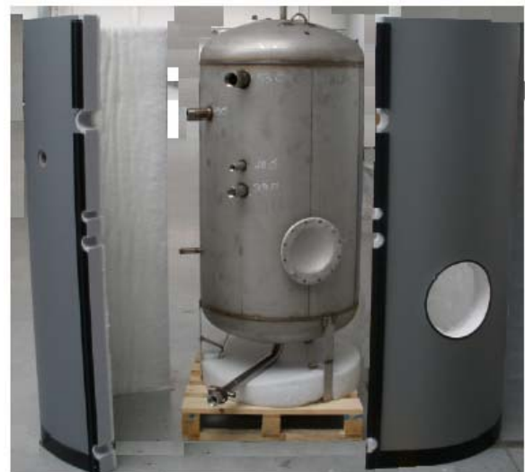
Montage der Deckeldämmung.
